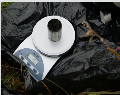
Figura 12. Pesaje de cilindro vacío, toma de muestra y pesaje de cilindro con muestra. Villarroel, 2018.
