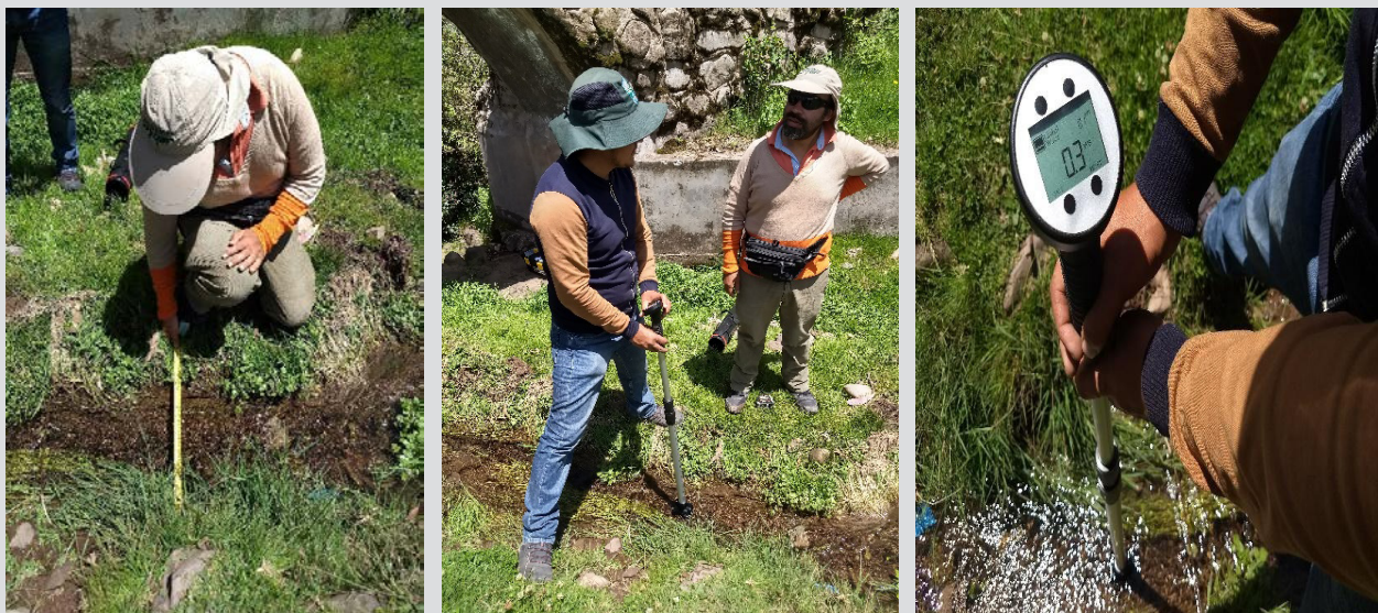
Figura 4. Procedimiento de medición de caudal con correntómetro. Autores 2018.
