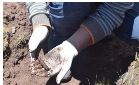
Figura 15. Cinta se fractura con facilidad. Autores, 2018.
