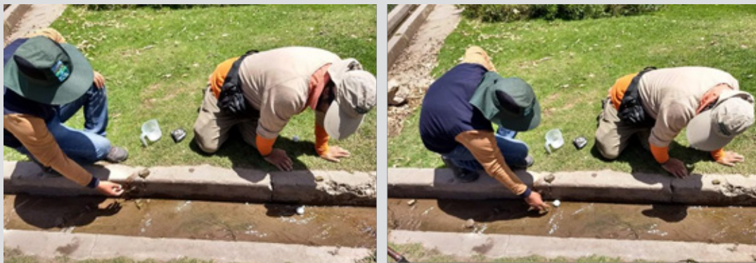
Figura 5. Procedimiento de medición de caudal sin correntómetro. Autores 2018.
